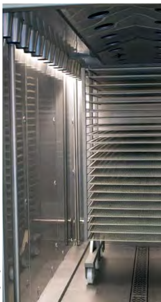
Der neue und verbesserte Aeromat II sorgt für eine gleichmäßige Luftverteilung in der Kammer.
