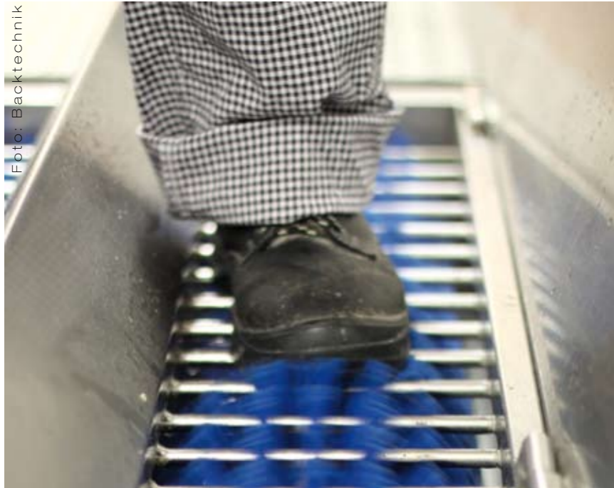
Bei der Sohlenreinigung wird der Schuh mit einem Wasser-Reinigungsgemisch gesäubert. Durch die Zugabe von Chlor in der Flüssigkeit wird der Schuh zugleich desinfiziert.
