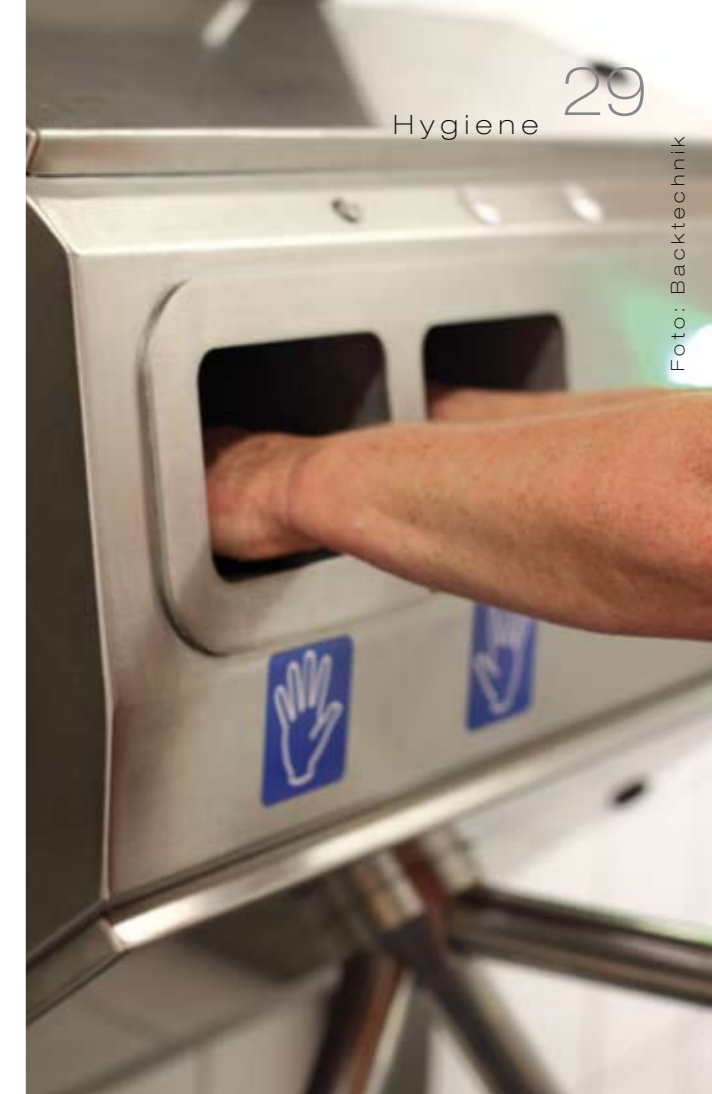
Jeweils zwei Düsen pro Hand sorgen dafür, dass die Hände großflächig mit Desinfektionsmittel eingesprüht werden.
